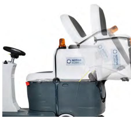
Snavsevandstanken kan vippe, så der er let adgang til batterirum og Ecoflex-systemet.
